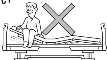
ボトムの支持部に大きな力がかかり、破損・変形の原因となります。
